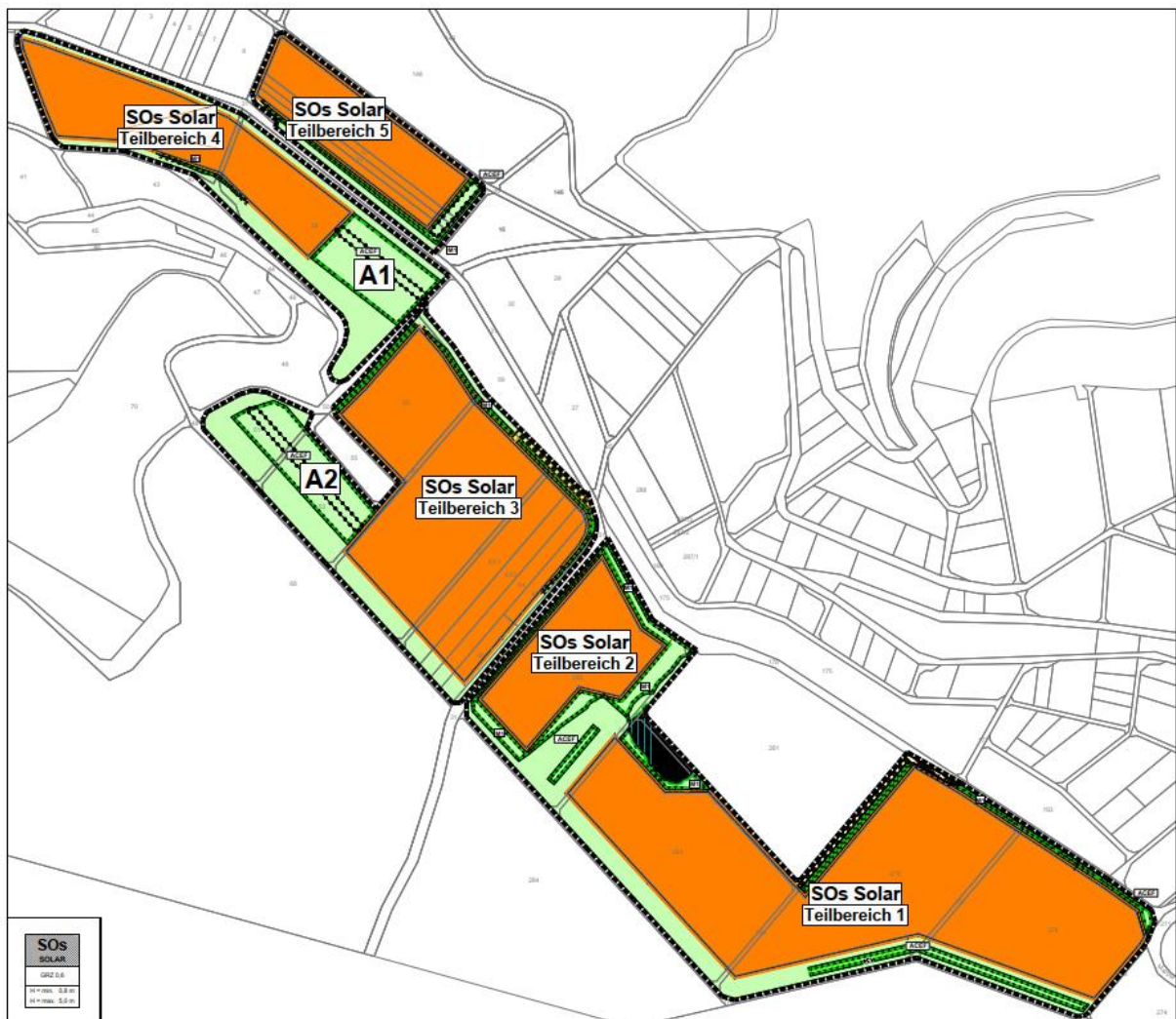
Abbildung 6: Geplante Flächenaufteilung des Solarparks Obergladbach – Modulflächen, Infrastruktur und Ausgleichsflächen
